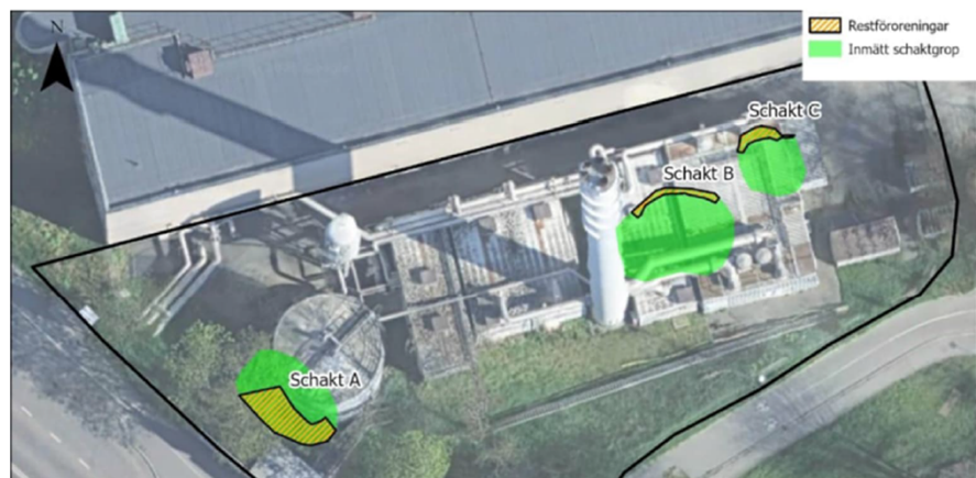
Bilden visar platsen före rivning samt lokalisering av schakt A, B och C. Gulmarkerade ytor visar på lokalisering av kvarlämnade restföroreningar. Schakter ligger inom planförslagets kvartersmark. WSP
